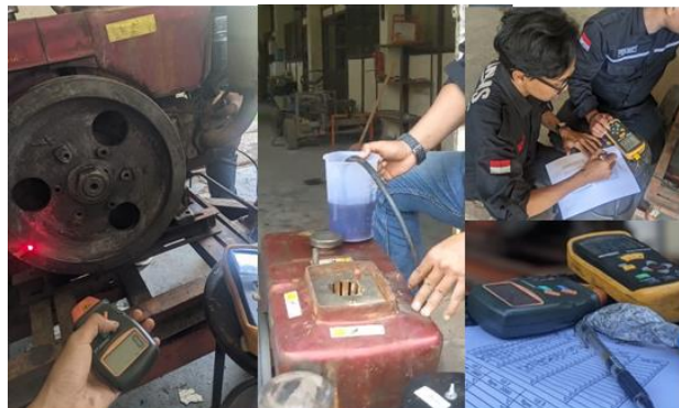
Gambar 1. Pengujian sistem pendingin standart
