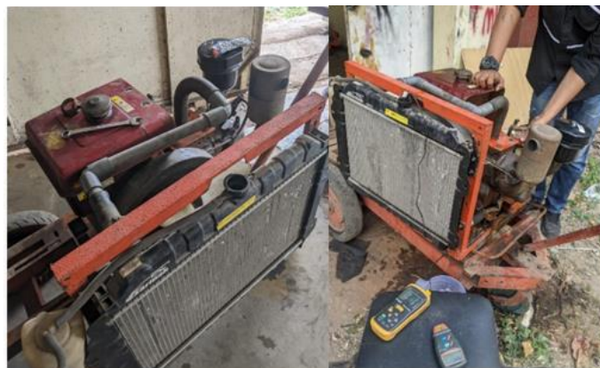
Gambar 2. Pengujian sistem pendingin radiator
